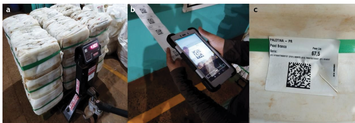
Figura 10. Pós-processamento: Pesagem (a.), apontamento (b.), etiquetagem (c.).
