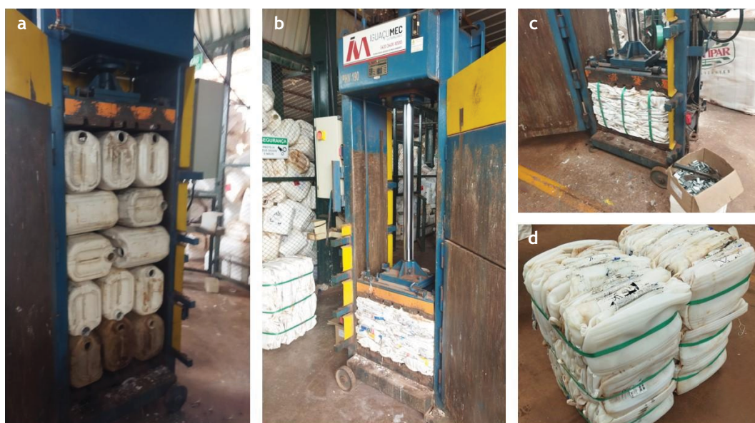
Figura 9. Processamento de embalagens não contaminadas: abastecimento (a.), prensagem (b.), arqueamento (c.), fardo (d.).
