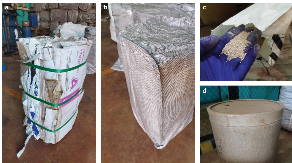
Figura 11. Acondicionamento de embalagens contaminadas processadas: fardo de embalagem flexível (a.), envelope individual (b.), vermiculita (c.) e barrica (d.).
